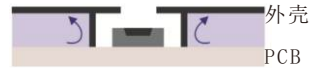
图2：传感器与外壳内部空气进行隔离，将外壳内部密闭空气对传感器的影响降到最低。
